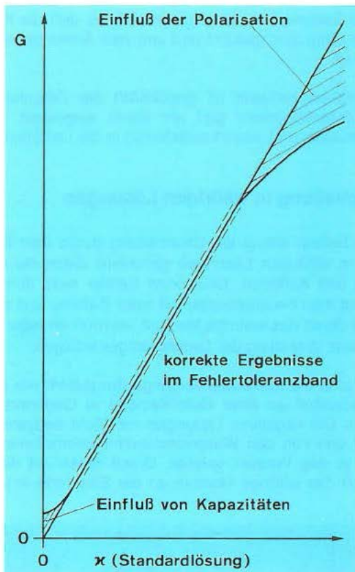
Abb. 2: Kennlinie einer Leitfähigkeitsmeßeinrichtung
