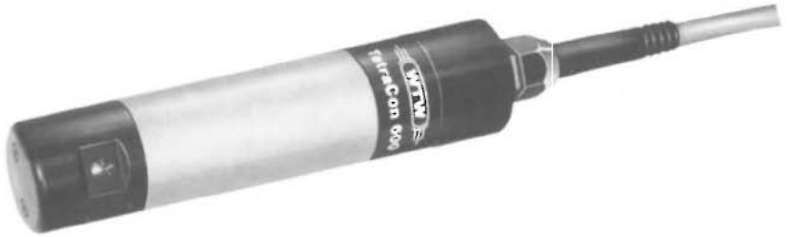
Abb. 13: Eintauchgeber mit Vier-Elektroden-Anordnung
